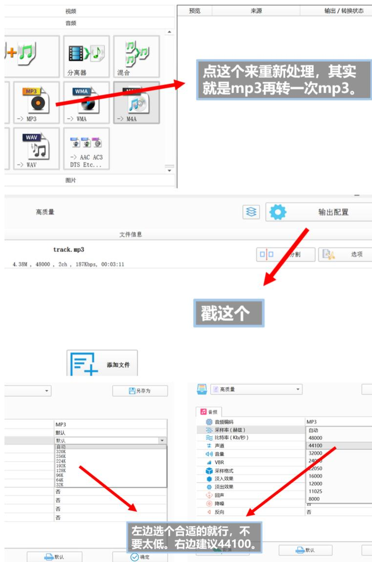
图 3.4: 音源处理样例 (格式工厂)
